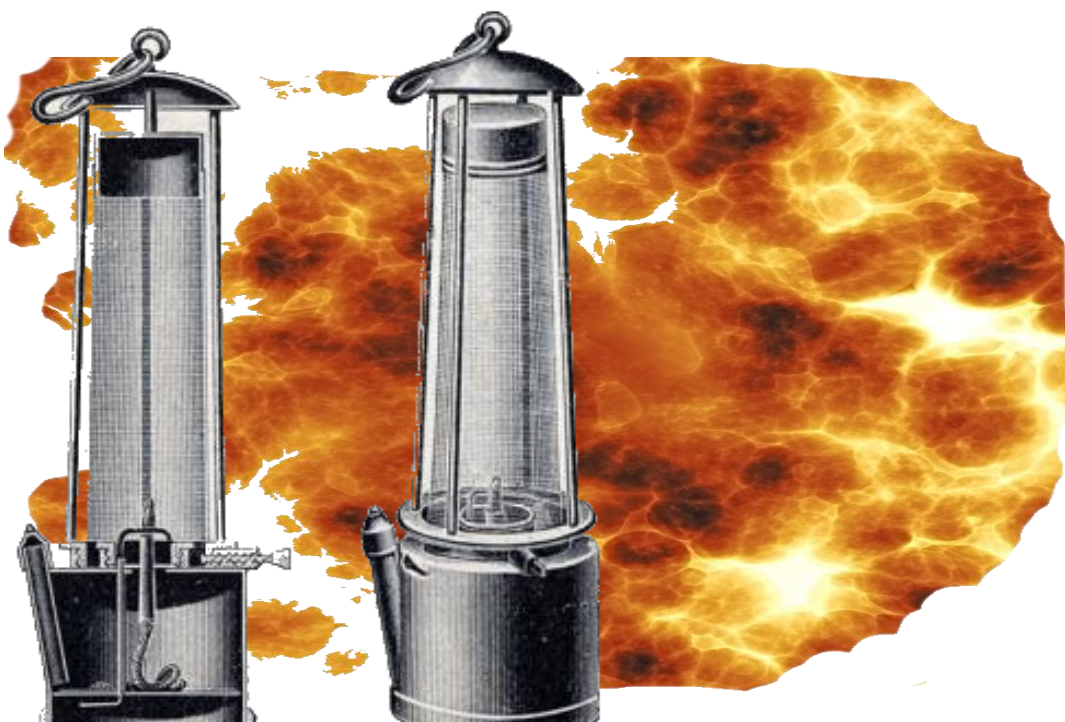
Grubenlampe mit Metallgaze gegen Schlagwetter
