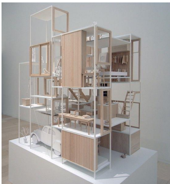
„offenes Wohnen“ – keine durchgehenden Geschossdecken – Split Level
