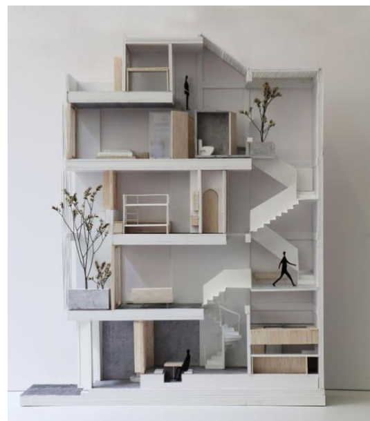
„offenes Wohnen“ – keine durchgehenden Geschossdecken – Split Level
